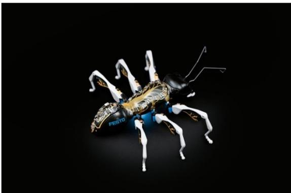
**Festo: «BionicANTs», 2015.** Robotische Ameise, lasergesinterter Polyamid, Federstahl, 4,3x13,5x15 cm. © 2016 Festo AG & Co. KG
