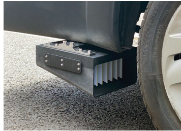
Reifenabriebauffanggerät, 2020/23 Start-up The Tyre Collective, UK Partikel des Reifenabriebs haften durch elektrostatische Ladung an Kupferplatten © The Tyre Collective
