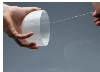
Lukas Keller: Luminaire-Cycle. PLA-Biokunststoff für kreislauffähige LED-Leuchten.
